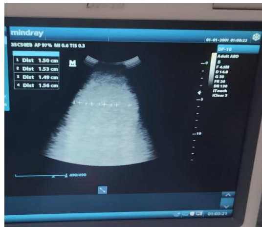
Gambar 3. Pengukuran akurasi jarak horizontal
