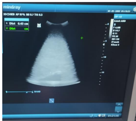
Gambar 9. Pengukuran lebar bayangan plat akrilik yang terukur pada citra USG
